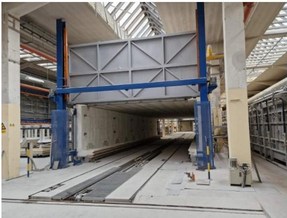
Vista posterior (seção de saída do forno com porta vertical)
