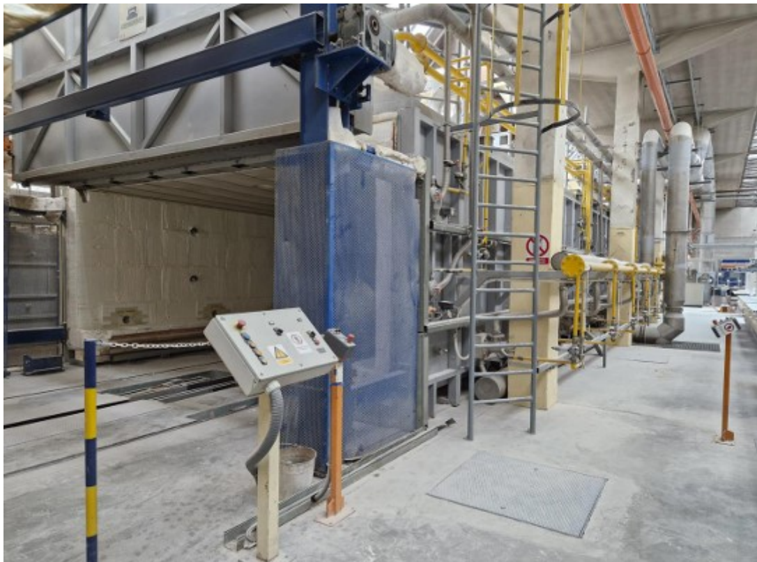
Destaque para a porta vertical e a unidade de controle de porta
