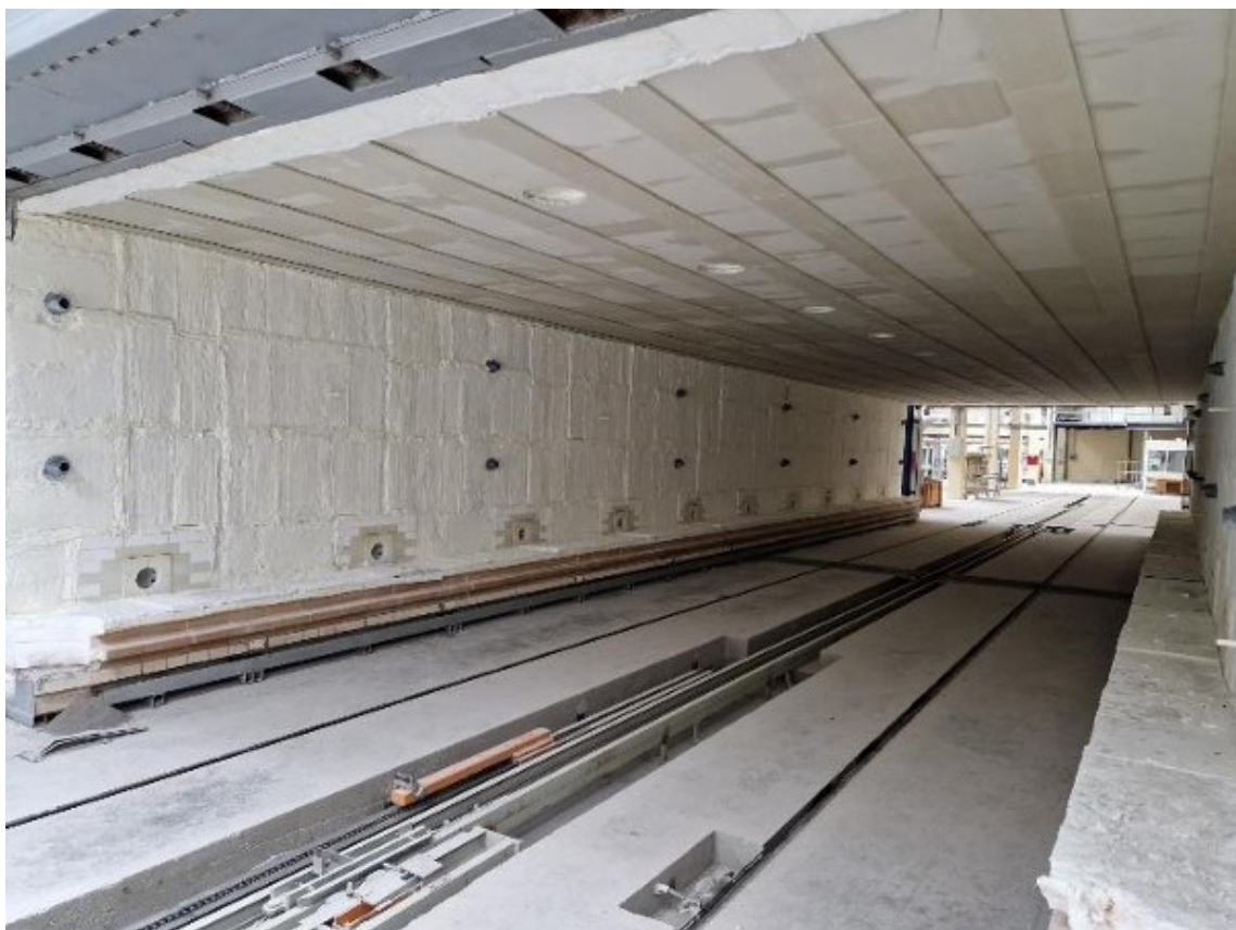
Interior do forno, com destaque para o isolamento e os queimadores
